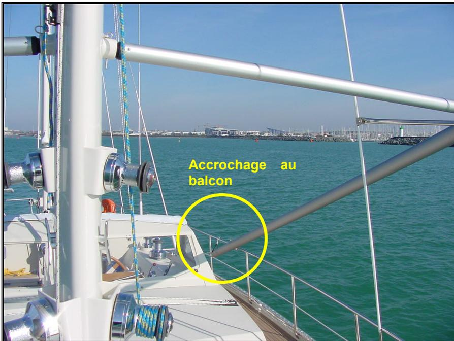
Figure 33 – Tangon assemblé au tangonnet et accroché au balcon
