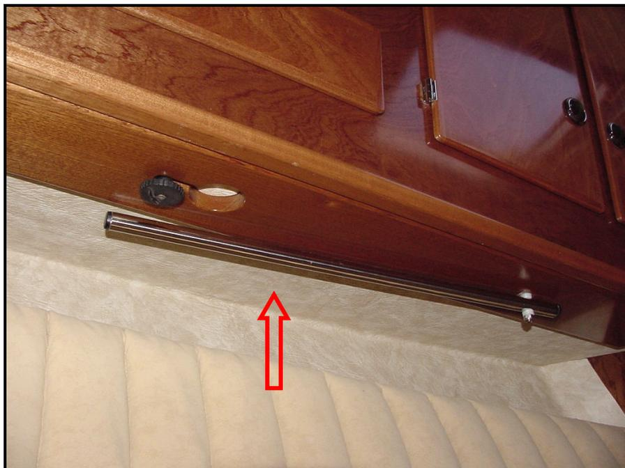
*Figure 82 – Rangement de la barre anti-roulis de la cabine avant*
