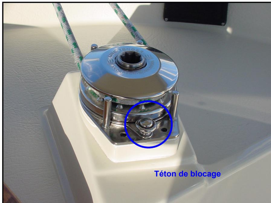
Figure 17 – Commande du chariot de barre d'écoute de grand'voile (photographié fixe)
