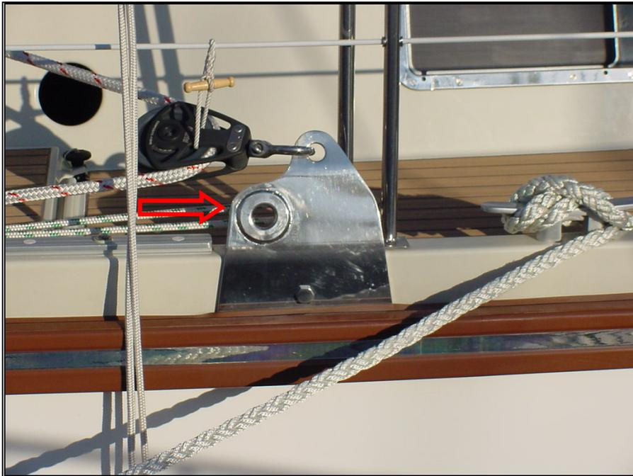
Figure 104 – Cadène de levage arrière
