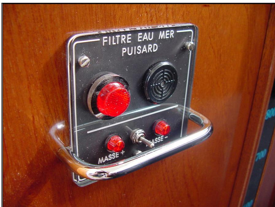
*Figure 2 – Interrupteur de recherche de masse défectueuse*
