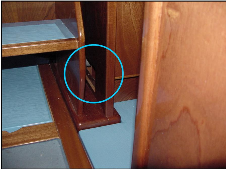
*Figure 79 – Aération du réfrigérateur*
