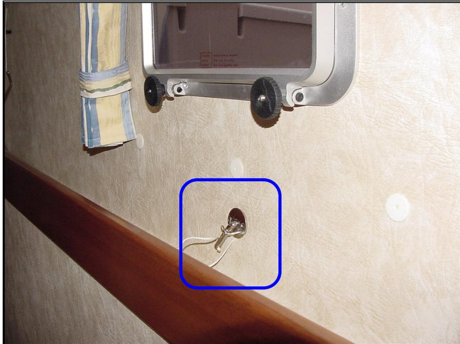
*Figure 57 – Blocage de l'ouverture du compartiment moteur*
