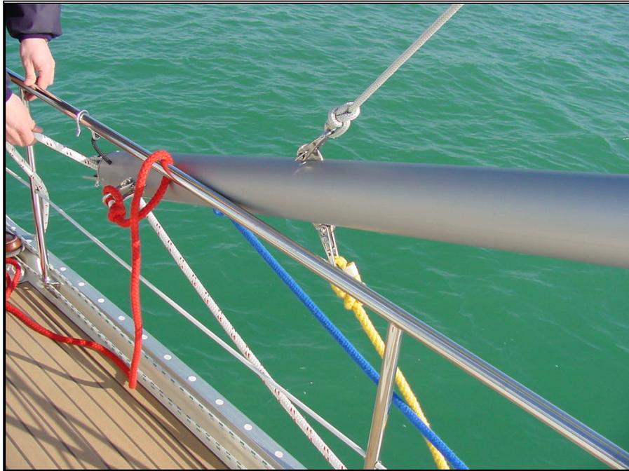
Figure 34 – Fixation des bouts sur le tangon et passage de l'écoute de foc
