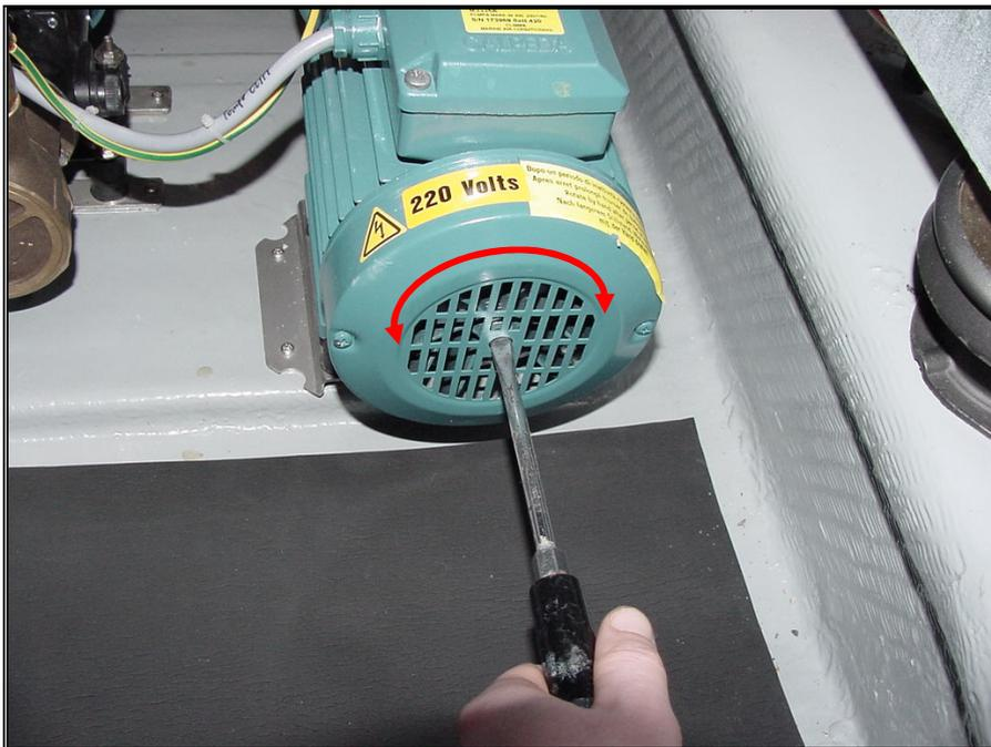
*Figure 76 – Pompe de climatisation du compartiment moteur*
