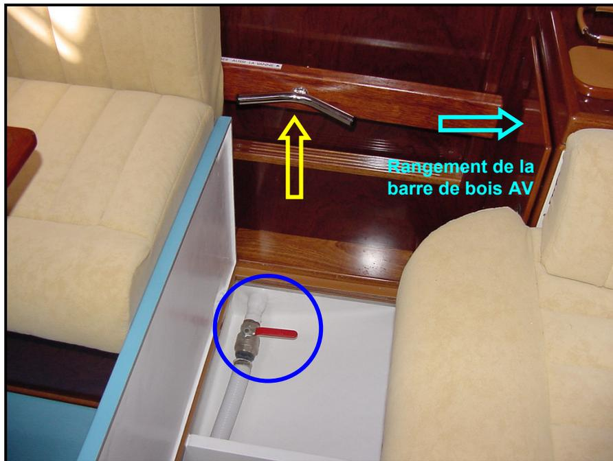
Figure 47 – Barre de bois d'étanchéité mise en place et vanne de fermeture de la douche avant (photographiée fermée)
