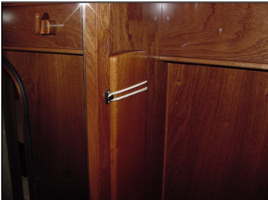
*Figure 86 – Rangement de la barre anti-roulis de la cabine arrière (version coiffeuse)*
