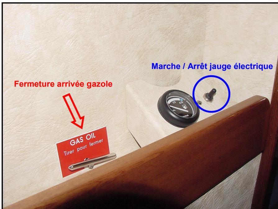
Figure 54 – Jauge de carburant et tirette de fermeture arrivée gazole depuis la coursive
