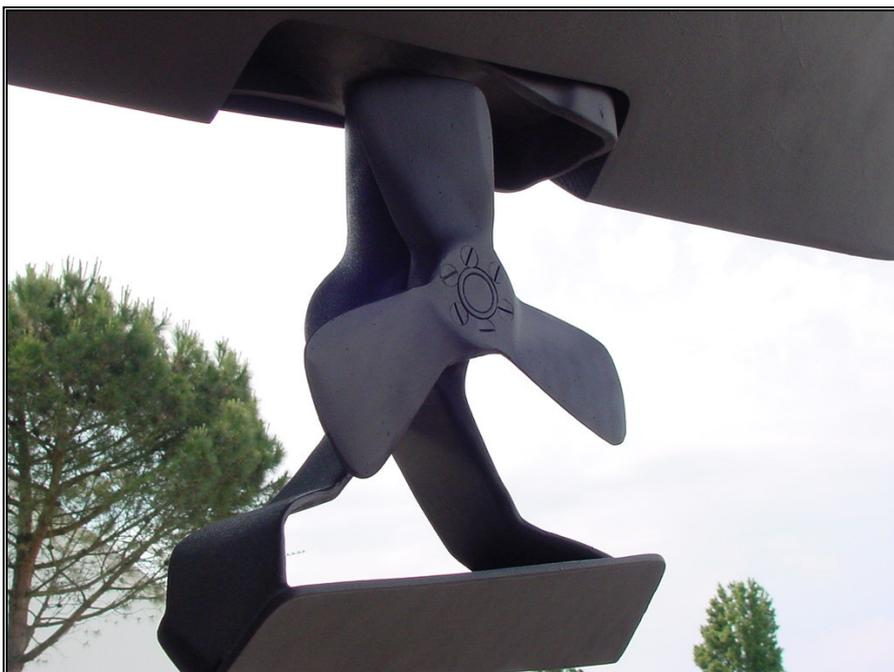
Figure 8 – Propulseur d'étrave
