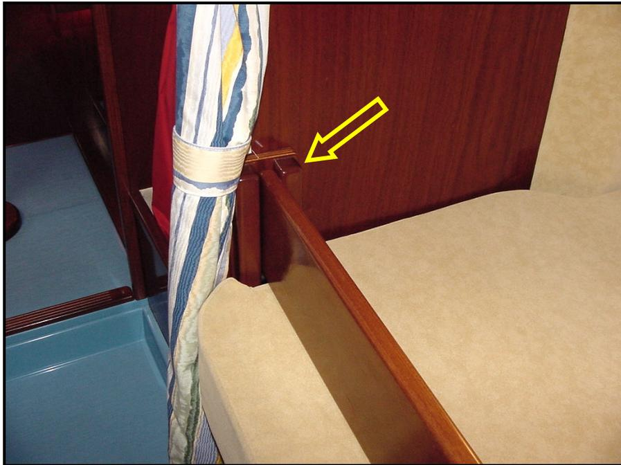
*Figure 85 – Barre anti-roulis de la coursive mise en place*
