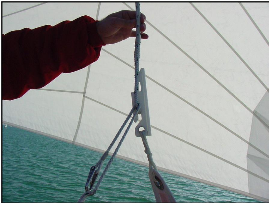
*Figure 38 – Crochet en plastique avec drisse de ballooner*
