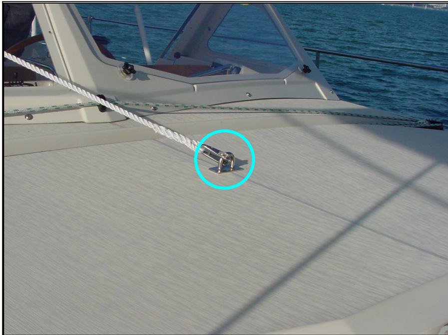
*Figure 43 – Fixation de l'amure du ballooner d'artimon*
