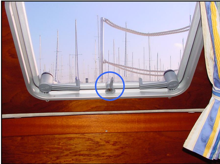
Figure 102 – Condamnation du panneau de la cabine arrière
