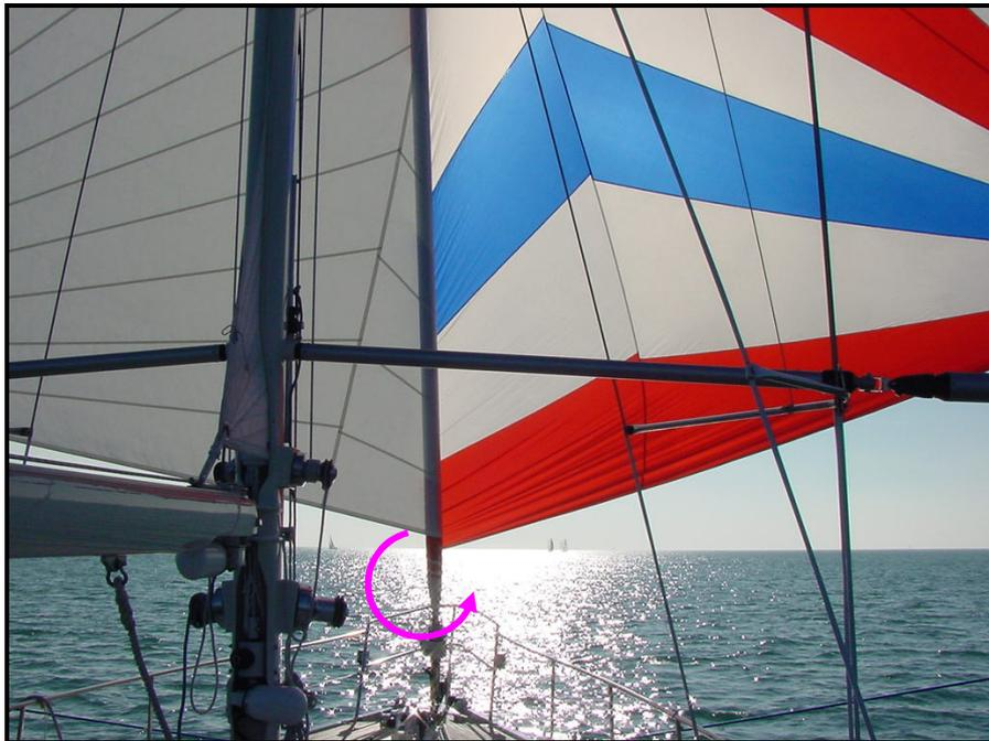
Figure 40 – Enroulement simultané du foc et du ballooner
