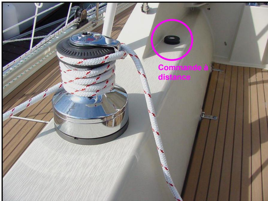
Figure 14 – Winch électrique d'écoute de foc
