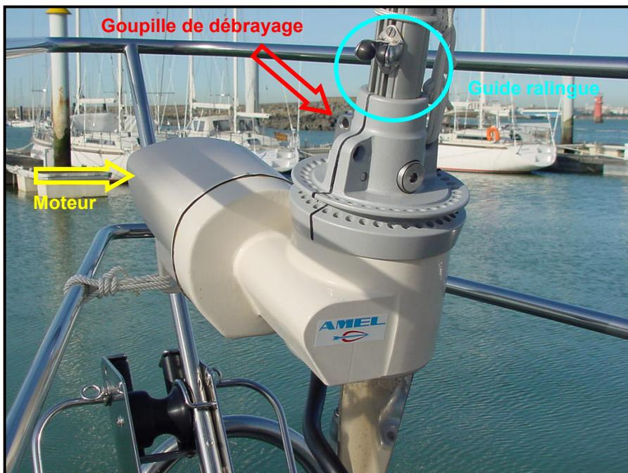
Figure 18 – Moteur de l'enrouleur de foc
