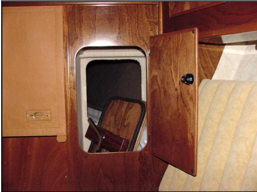
*Figure 92 – Trappe étanche du puits à chaîne*
